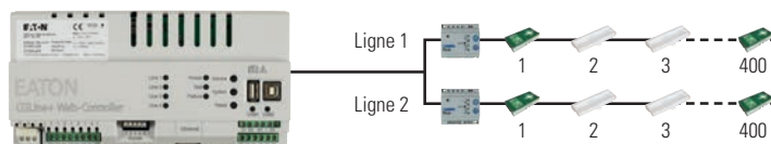
Installation typique max. 4 lignes de 200 blocs autonomes chacune (ci-dessus) ou 2 lignes de 400 blocs chacune (ci-dessous).
